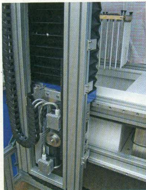
Bei During kommen Alu-Linearschienenführungen zum Einsatz. Durch ihr geringeres Gewicht im Vergleich zu Ausführungen aus Stahl ist die Anlage leichter gebaut. (Fotos: Dr. Tretter)
