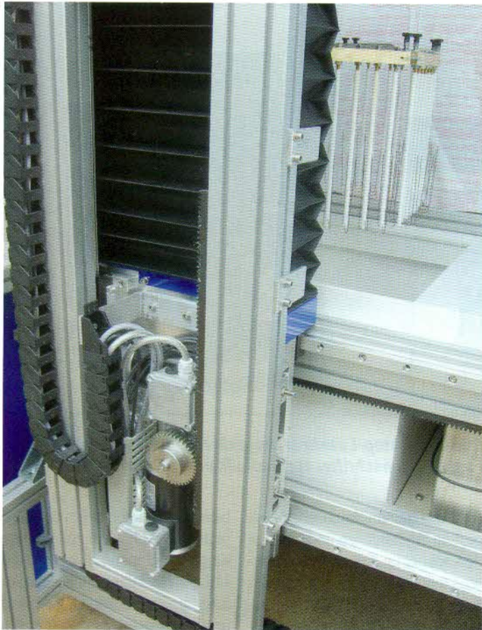
Bild 3: Zum Einsatz kommen Alu-Linearschieneführungen. Durch ihr geringeres Gewicht im Vergleich zu Ausführungen aus Stahl, ist die Anlage leichter konstruiert und gebaut.
